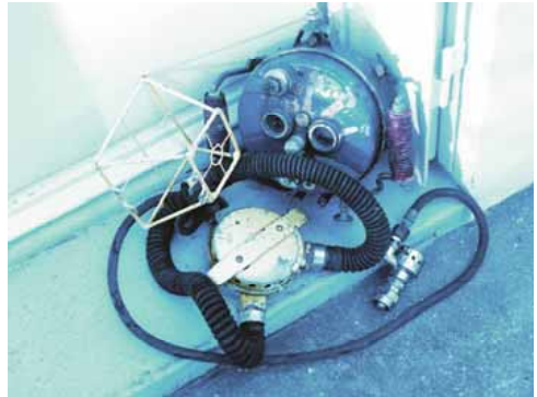
Boîte et détendeur que j'avais fabriqués à Sydney pour plonger et faire des photos
